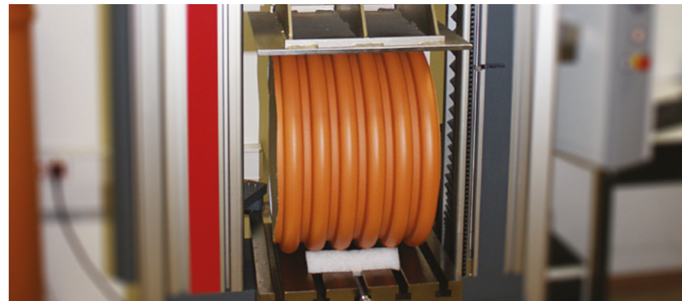
лабораторные испытания трубы Polytron ProKan
